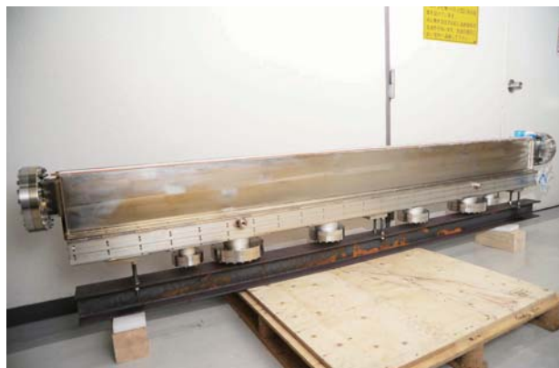
新規に製作したU5アンジュレータ用新真空槽
