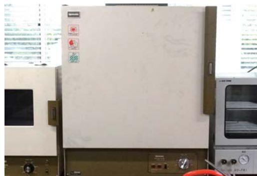
写真1 オーブン温調器 (改造前)
