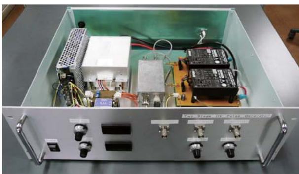
図4 2段式高電圧パルス発生器の外観と入出力波形
