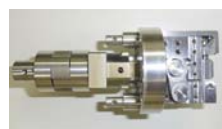
高磁場超伝導線材の引張歪印加機構プローブ
