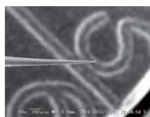
STM用クロムプローブの放電加工
