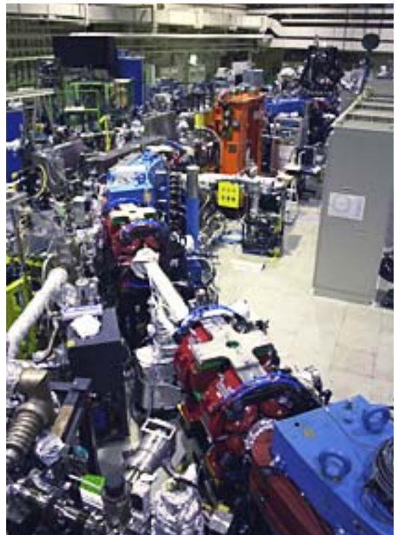
図5 (a)真空封止型アンジュレータ1号機。超伝導ウイグラの跡地に設置された。(b)真空封止型アンジュレータ磁極。真空チャンパー中に表面処理を施された永久磁石が並んでいる。
