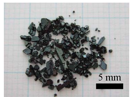
図3 セブンナインC 60 の写真。大きさは2 mm x 2 mmに達する。
