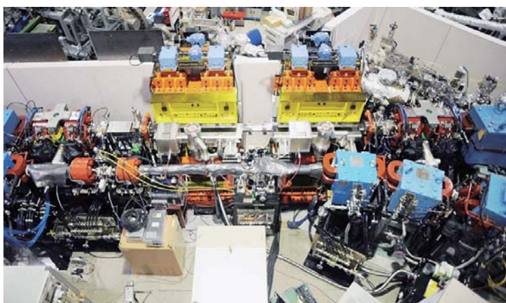
図2 可変偏光アンジュレータ装置。
