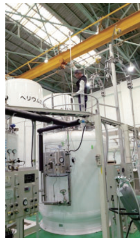
図5 貯槽のトランスファーチューブ。 液が溜まった後でもう一度抜いて取り付けた。
