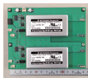
図1 開発した高電圧モジュール搭載プリント基板
