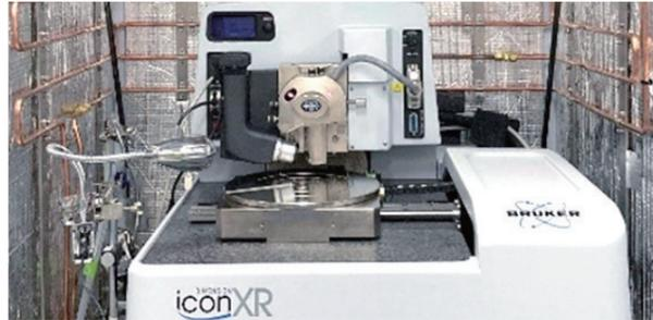
蓄電池、太陽電池、燃料電池などのデバイス稼働下で起きるエネルギー移動反応中の材料の分子構造、機械特性、電子特性、電気特性、磁気特性などの物性をナノレベルかつ時間分解能で解析し、反応機構を解明できる走査プローブ顕微鏡システムです。国内の企業や大学と共同し、時間分解測定技術、超高速スキャナー技術、超低振動環境制御技術などの要素技術を独自開発し、デバイス動作(オペランド)環境において、1nmの空間分解能かつ80psの時間分解能で、反応機構や物性を解析する世界初の走査プローブ顕微鏡を開発しています。
