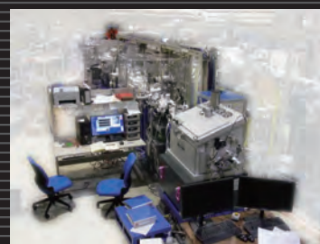
UVSORのシンクロトロン光を用いた走査型透過X線顕微鏡装置 Scanning Transmission X-ray Microscope utilizing synchrotron radiation from UVSOR.
