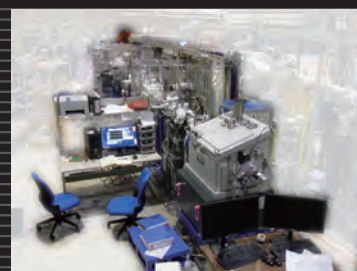
UVSORのシンクロトロン光を用いた走査型透過X線顕微鏡装置
