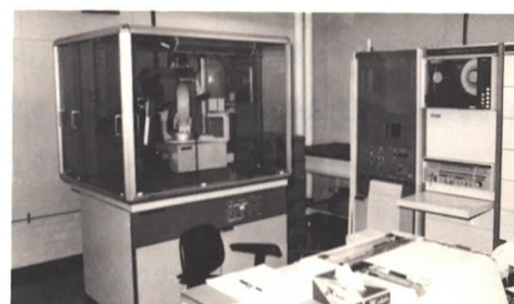
4軸型単結晶X線回折装置
