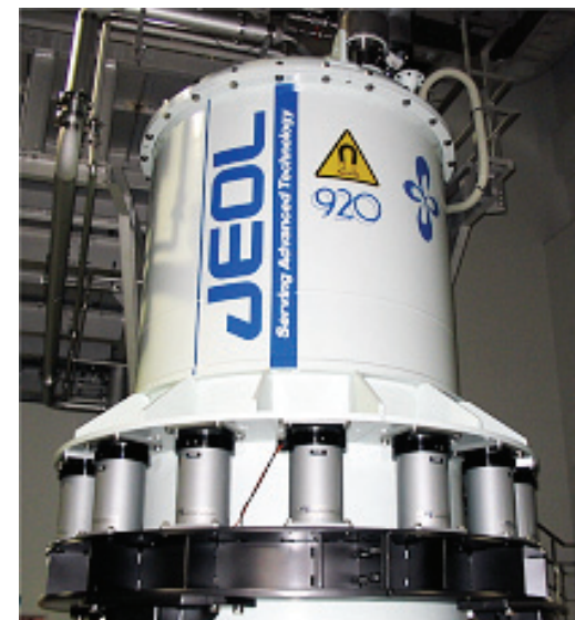
超高磁場920MHz NMR装置
