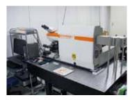
**Figure 3.** Raman microscope (Renishaw INVIA REFLEX532).
