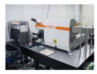
**Figure 3.** Raman microscope (Renishaw INVIA REFLEX532).
