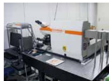
**Figure 3.** Raman microscope (Renishaw INVIA REFLEX532).
