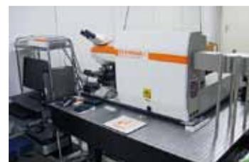
**Figure 3.** Raman microscope (Renishaw INVIA REFLEX532).
