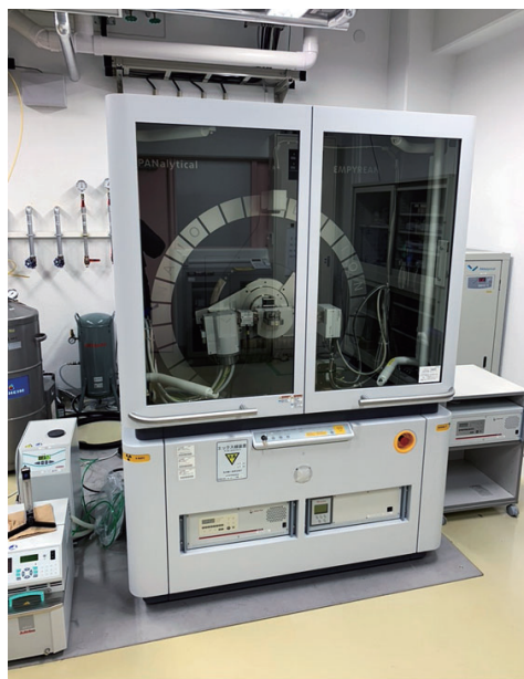
図1 マルバーン・パナリティカル社製多目的オペランドX線回折（XRD）装置Empyrean。
