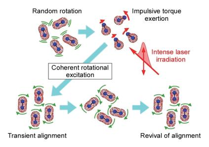
図1 非断熱回転励起の模式図
