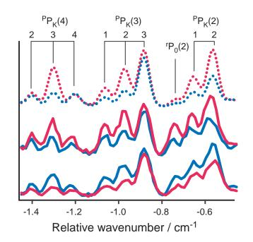
図8 M分布の偏りに関する実験的検証 パルス対励起後に測定したベンゼンの  $S_1 \leftarrow S_0 \ 6_0^1$ バンドのPブランチ領域を示す。遅延時間は $7.3 \ ps$ 。青線と赤 線は、それぞれ、右および左偏光プローブに対応する。中段と下段のスペク る計算結果。
