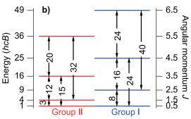
図 5 NO分子の非断熱回転励起過程 (a) 図 4 の各回転状態分布の時間 依存性をフーリエ変換して得たパワースペクトル。(b) NO  $(X^2\Pi_{1/2})$  の回転エネルギーダイアグラムと J=0.5 からの非断熱励起経路。
