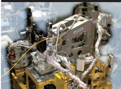
UVSORで開発した次世代透過型軟X線分光器。
