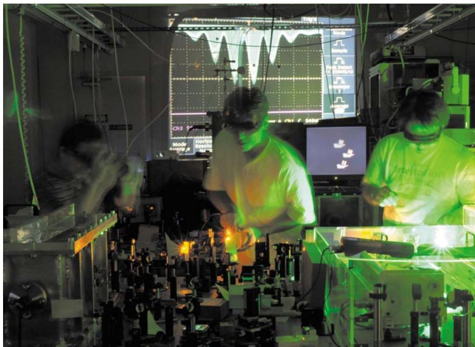
図3 実験風景。正面の壁に投影された画面は、APMから出射された2個のフェムト秒レーザーパルス対を分光器に入射して測定したスペクトル干渉である。このスペクトル干渉の山や谷の位置が横方向にぶれなければ、空間的に隔たった2個のフェムト秒パルスの位相差が安定していることになる。このときの実験条件では、隣り合った山と山の間隔が約850アト秒に相当している。この写真は8秒露光で撮られたものだが、その間ぶれが見られない。実際に40分以上の連続測定を行うことが多いが、その間もこの壁上の干渉波形はほぼ静止している。撮影：由利修一
