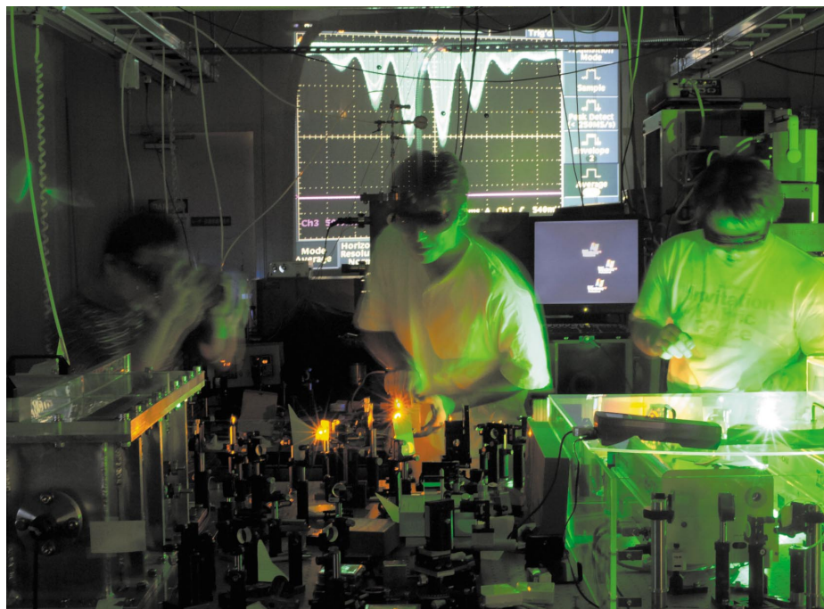
図3 実験風景。正面の壁に投影された画面は、APMから出射された2個のフェムト秒レーザーパルス対を分光器に入射して測定したスペクトル干渉である。このスペクトル干渉の山や谷の位置が横方向にぶれなければ、空間的に隔たった2個のフェムト秒パルスの位相差が安定していることになる。このときの実験条件では、隣り合った山と山の間隔が約850アト秒に相当している。この写真は8秒露光で撮られたものだが、その間ぶれが見られない。実際には40分以上の連続測定を行うことも多いが、その間もこの壁上の干渉波形はほぼ静止している。撮影：由利修一
