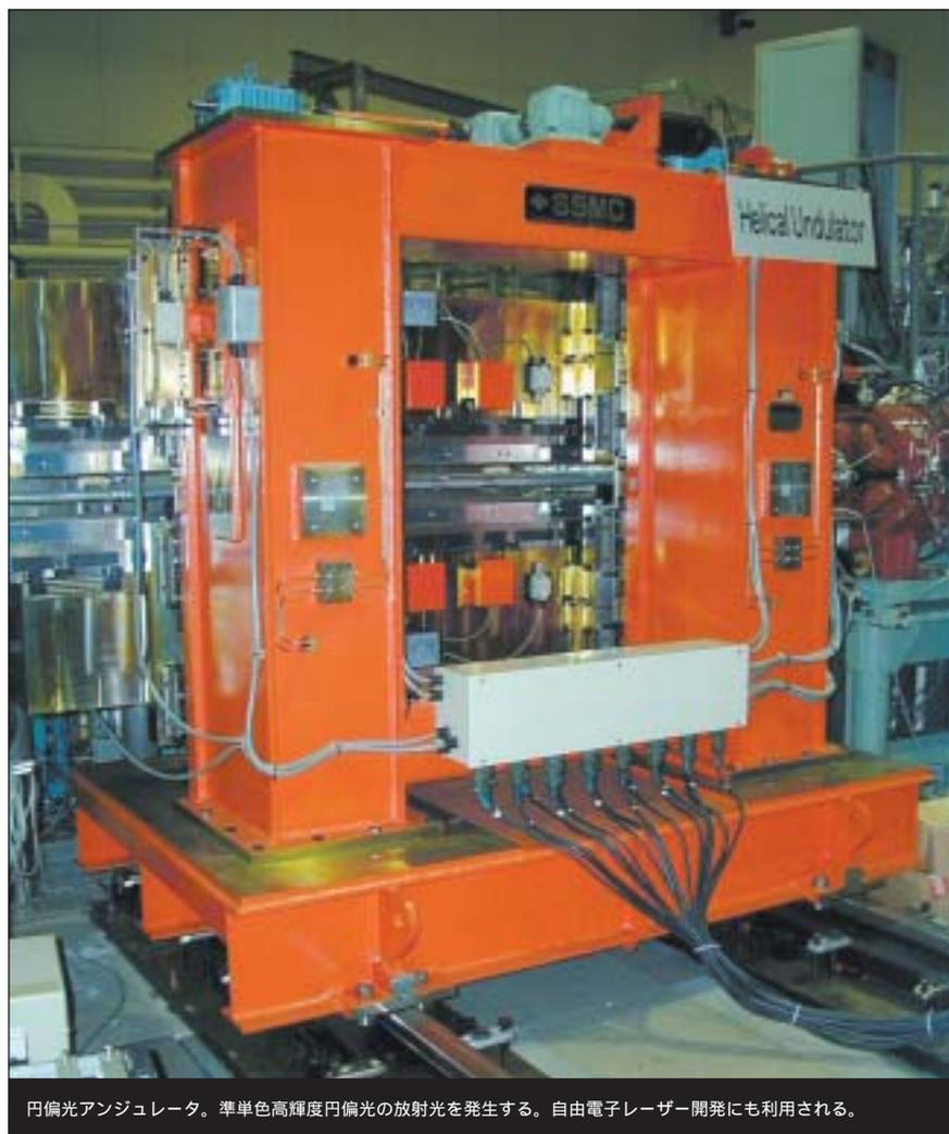
円偏光アンジュレータ。準単色高輝度円偏光の放射光を発生する。自由電子レーザー開発にも利用される。
