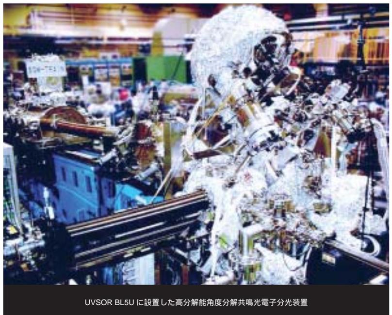
UVSOR BLSU に設置した高分解能角度分解共鳴光電子分光装置
