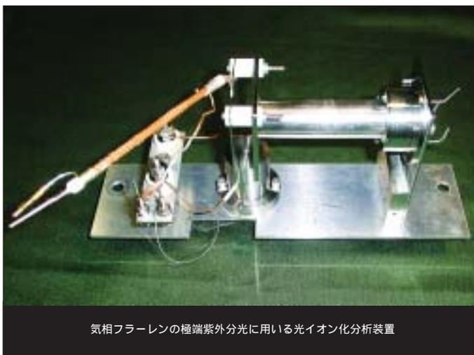
気相フラーレンの極端紫外分光に用いる光イオン化分析装置
