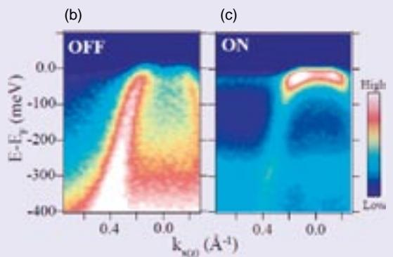
UVSOR-II BL7U 真空紫外角度分解光電子分光ビームライン (a) と CeCoGe<sub>1.2</sub>Si<sub>0.8</sub> の 4d-4f 共鳴角度分解光電子分光イメージ。(b) は非共鳴での分散曲線で、主に Co 3d バンドを表し、(c) は共鳴での分散曲線で、主に Ce 4f バンドを表す。
