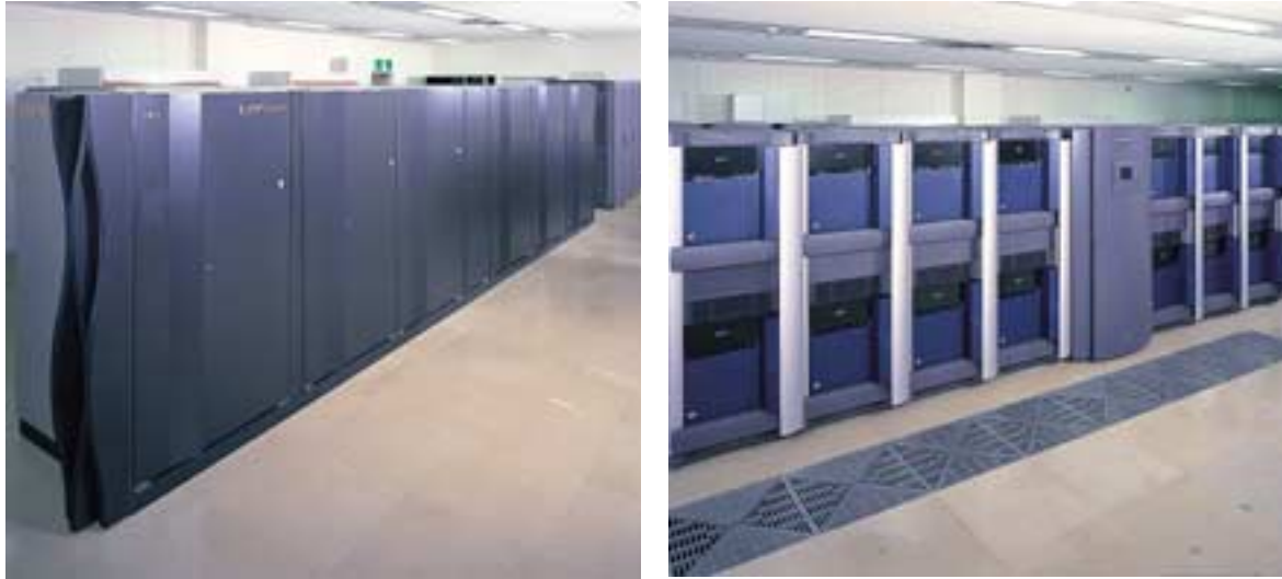
写真1 主機室に配置されたVPP5000（左）とSGI2800（右）
