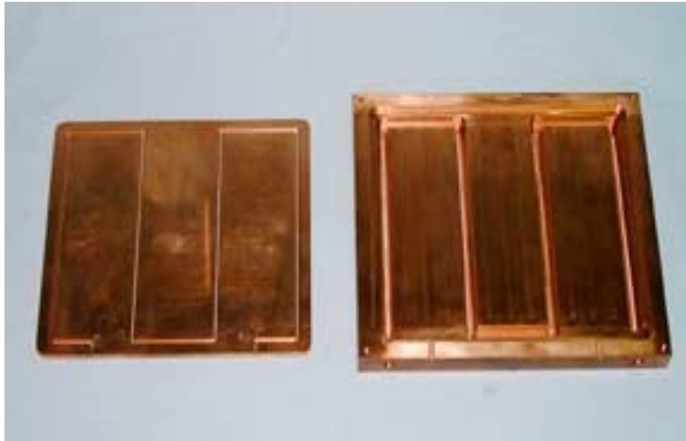
写真2 ロウ接前の温調プレート
