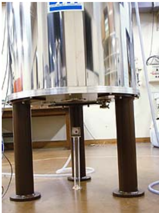
図1 水の磁気浮上 磁石の下の方の鏡に映っている球が磁気力により空中に浮いている水滴である。
