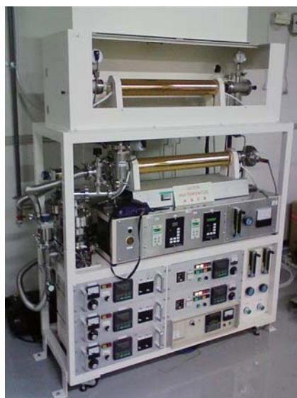
図2 結晶析出昇華精製装置の写真。温度勾配下、窒素、水素雰囲気中で、対流を起こすことにより、有機単結晶を作製できる。
