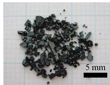
図3 セブンナインC 60 の写真。大きさは2 mm x 2 mmに達する。
