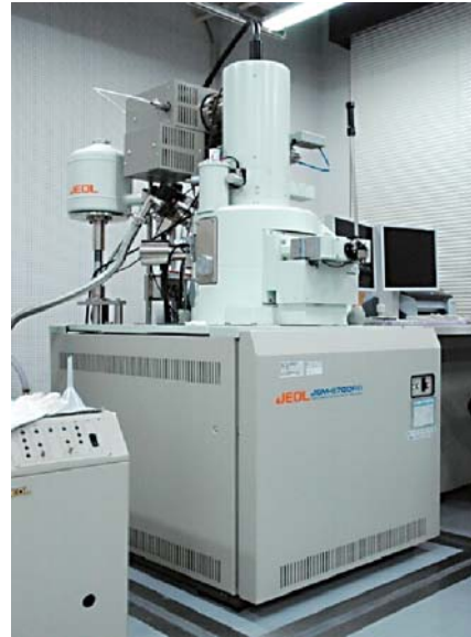
図4 集束イオンビーム加工機 JEOL FIB: JEM-9310FIB (山手4号館1階SEM室)。試料の直径1インチまで、SEM用断面試料加工やTEM用薄片試料加工が行える。走査型イオン顕微鏡(SIM)、100 nm程度の組成構造観察、部分的カーボンCVD蒸着が可能。
