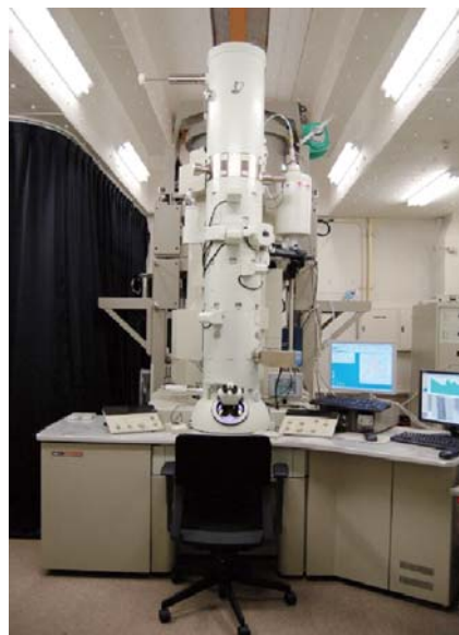
図2 300kV透過型分析電子顕微鏡JEOL JEM-3200(明大寺実験棟B10)。粒子像分解能0.17 nm、格子像分解能0.10 nm。電界放出型エネルギーフィルターを有する。走査像の観察も可能で、電子エネルギー損失分光も行えるので、元素分析が可能である。試料は液体窒素により冷却できる。
