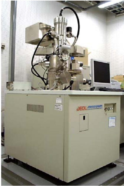
図3 電界放射走査電子顕微鏡 JEOL FE-SEM: JSM-6700F (山手4号館1階SEM室)。試料の直径4インチまで、倍率は最高65万倍(数 nmまで)。エネルギー分散型X線分析(EDS)、表面元素定性分析、定量分析、面分析が可能。
