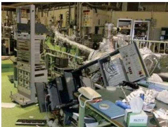
図1 放射光実験ホールでの制御ラックの転倒。
