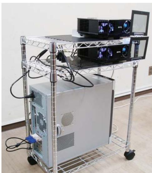
図4-1 偏光式三次元立体表示システム
