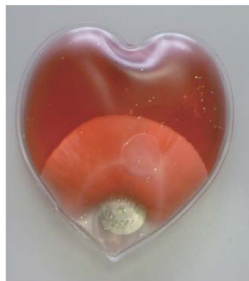
図3 固体(下部)に変わっていく途中のエコカイロ。
