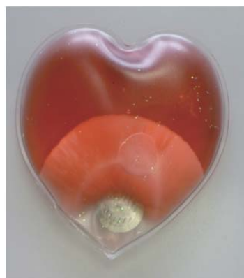
図3 固体(下部)に変わっていく途中のエコカイロ。
