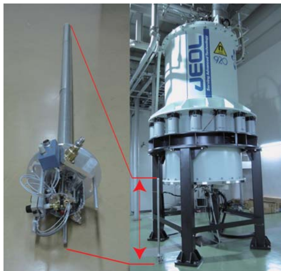
図5 独自に開発した920MHz超高磁場NMR用温度可変MASプローブ、および920MHz超高磁場NMR用超電導マグネット全景。
