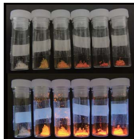
図3 ピペラジン-ピラジン混合配位高分子。左から、反応比率10:0, 9:1, 7:3, 3:7, 1:9, 0:10で合成した試料。上: 蛍光灯下、下: 紫外線照射下。
