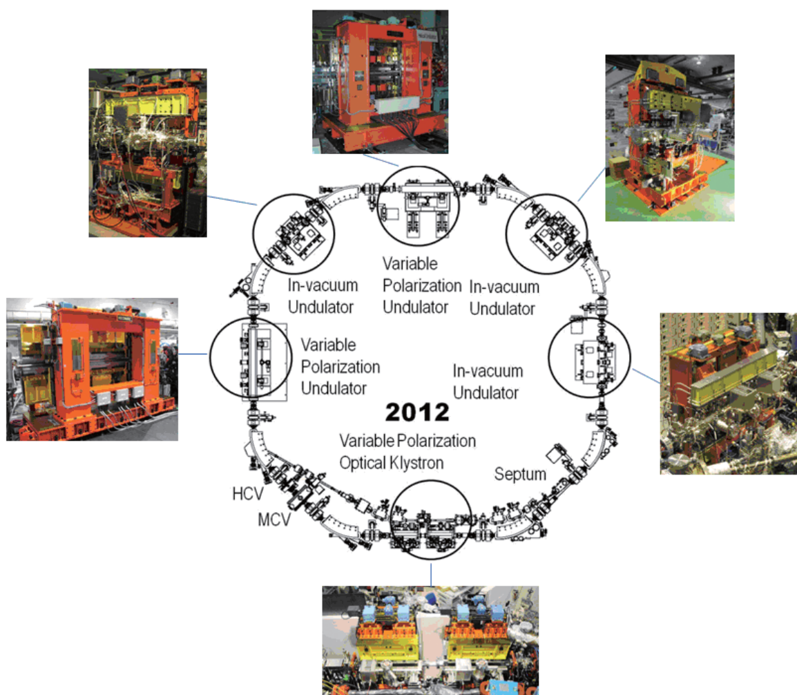
図 UVSOR-III光源加速器の機器配置。周長50mの電子蓄積リングに6台のアンジュレータ装置が装着された。
