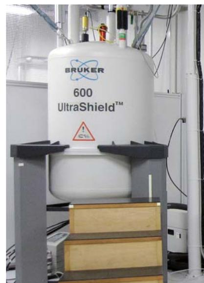
Bruker AVANCE 600型溶液・固体NMR装置
