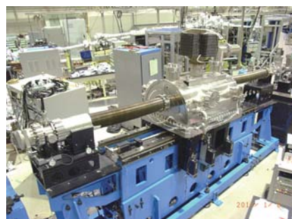
図4 複合入射型分光器（SGM-TRAIN）
