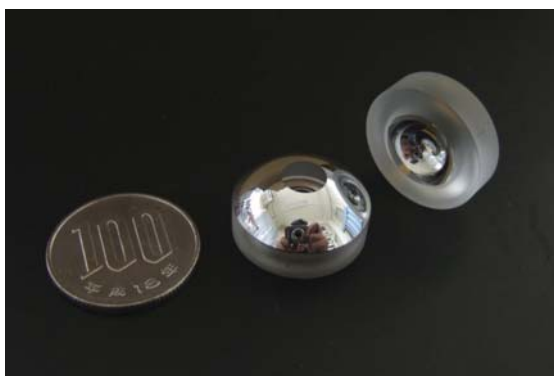
現分子研大島グループの藤原正規博士が、卒論から修論の3年間で開発した反射対物レンズの写真。この対物レンズの開発により、当該研究に成功したと言って過言ではない。
