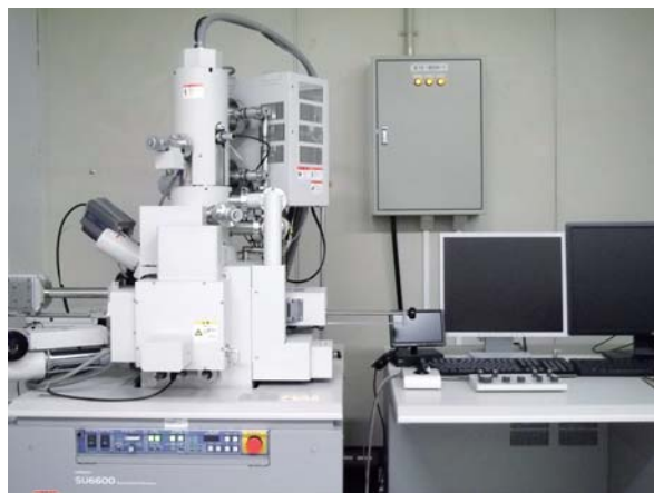
図1 低真空対応分析走査電子顕微鏡の外観。低真空対応SEMの(株)日立ハイテクノロジーズ製SU6600とエネルギー分散X線スペクトル測定装置であるブルカー・エイエックスエス(株)製QUANTAXシステムを組み込んだ機器である。
