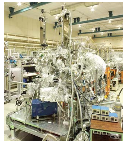
図3 UVSOR BL5Uに取り付けられた新しい角度分解光電子アナライザー。
