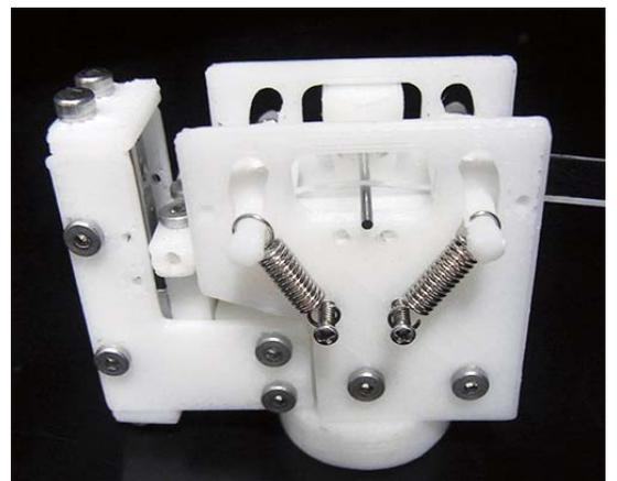
3D造形した部品を組立て製作した曲げ機構
