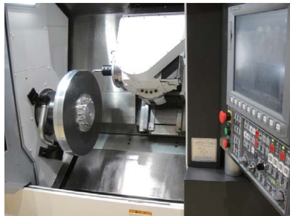
写真2 アルミ円盤からの削り出し。
