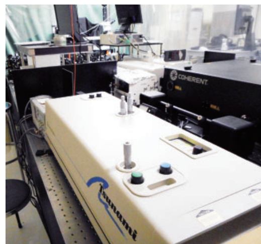
写真1 手前のレーザーがチタンサファイアレーザー「Tsunami」。
