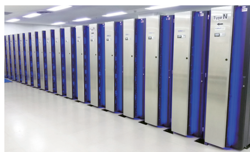
図2 演算ノードのラック（一部） 写っているラックには大規模演算向けのノード（合計約800台）が搭載されています。
