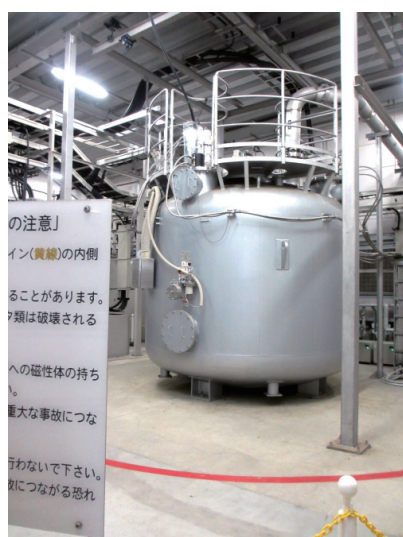
図1 SMESの貯槽。貯槽上部に設置した冷凍機3台で蒸発ガスを再凝縮し、温度上昇およびヘリウムの蒸発を抑えている。赤線は5 mT磁場ライン。
