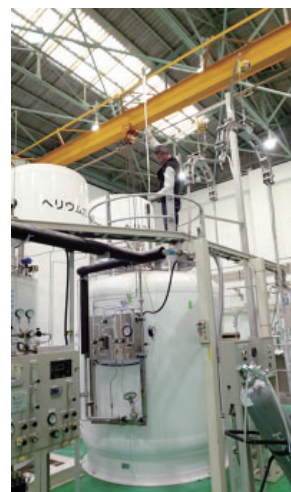
図5 貯槽のトランスファータブ。 液が溜まった後でもう一度抜いて取り付けました。
