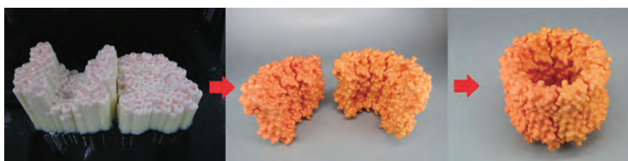
図5 72 mm×86 mm×59 mmと72 mm×79 mm×42 mmのパーツを組み合わせ、89 mm×76 mm×86 mmの模型を作成
