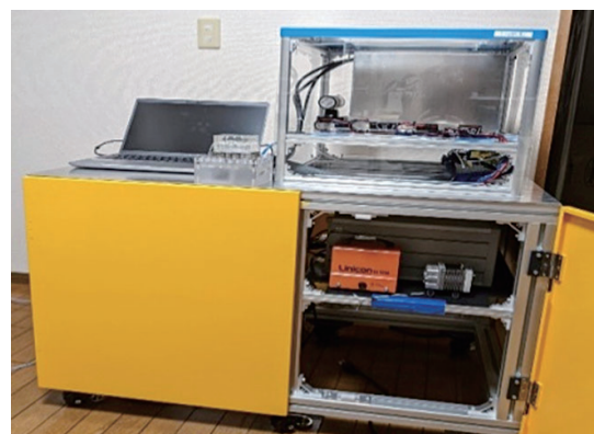
図2 1年以内での実用化をめざしている、4チャンネル培養型プレーナーパッチクランプ装置。
