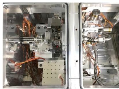
走査型透過軟X線顕微鏡チャンバー
