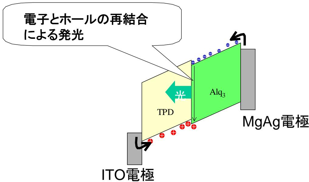
素子に電圧を印加することによって、プラス極(ITO)側からはホールが、マイナス極(MgAg)側からは電子が、有機薄膜中に注入される。両者は電界に沿って有機薄膜中を移動し、界面で出会う。この時ホールと電子が再結合することによって発光分子( $\text{Alq}_3$ )の励起状態が生成し、それが基底状態に落ちるときにフォトンを放出する。ホール輸送層(NPB)は電極からのホール注入と輸送を助け、また、反対から来た電子をブロックして閉じ込めて再結合効率を高める。このように、有機ELの性能は、「いかにたくさんのホールと電子を、バランスよく注入できるか」によって決まる。
